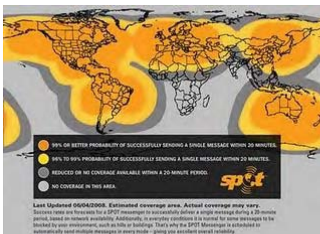
Fig 6. Ontvangst bereik van het SPOT-systeem gebaseerd op Globalstar satellieten.
